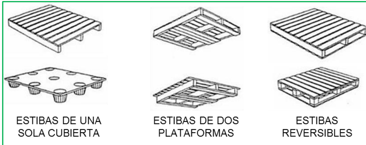
Estibas por su piso y cubierta
